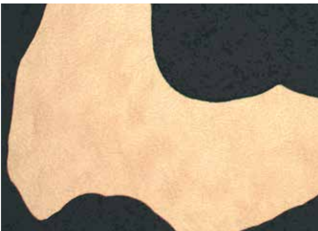
Abb. 1a: Einer der Hauptvorteile von CAD/CAM liegt in der möglichen reproduzierbaren, sehr hohen Materialqualität. Diese Qualität muss aber vom Materialhersteller mit einer hohen Verlässlichkeit geliefert werden und darf kein Zufall sein. Das Gefügebild einer Krone (OK5, C.HAFNER, Wimsheim) zeigt, dass der Patient quasi automatisch ein homogenes Gefüge erhält. Hochgoldhaltige Legierungen sind aber nicht deshalb zwangsläufig biokompatibel, weil sie diesen Nimbus besitzen. Ich muss sie als Hersteller auch dazu in die Lage versetzen.
