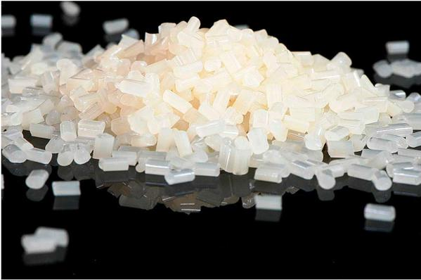
●22 Eingefärbtes Polycarbonat – Compound für die industrielle Blankherstellung. Für Snap-On Smile Schienen werden Polymere benötigt, die leicht elastisch, ausreichend reißfest, transluzent sind, einen zahnähnlichen Brechungsindex haben, sich ästhetisch einfärben lassen und dünn auslaufend fräsbearbeitbar sind.
