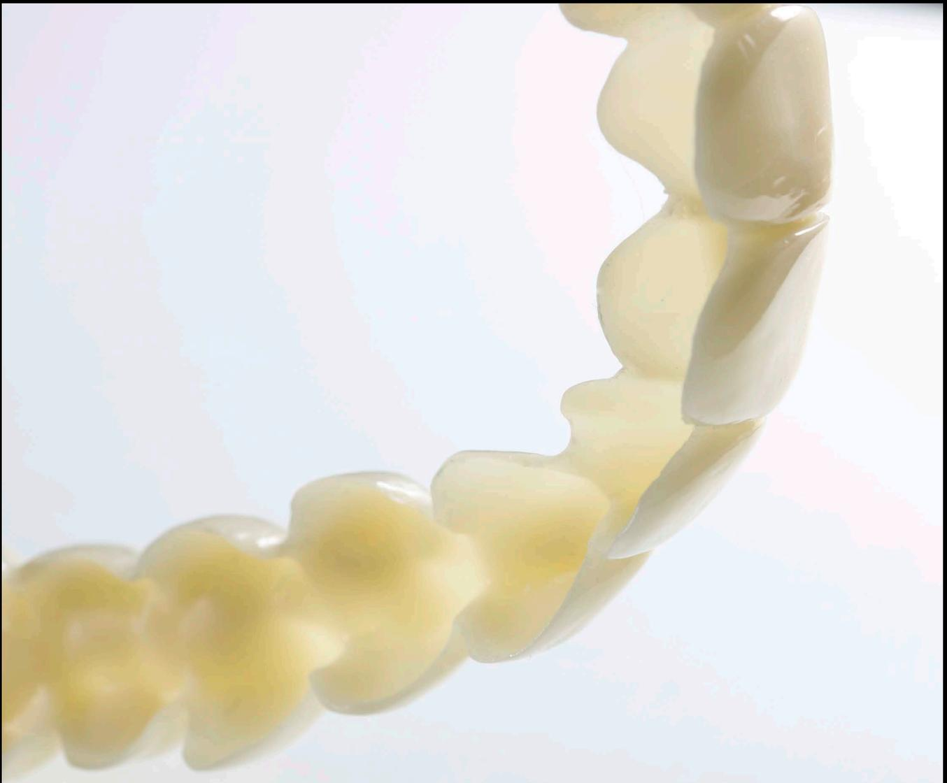
● 18 Bei dieser Aufnahme erkennt man im Durchlicht Areale, die maximal 0,2 mm dick sind und aufgewachste Regionen
