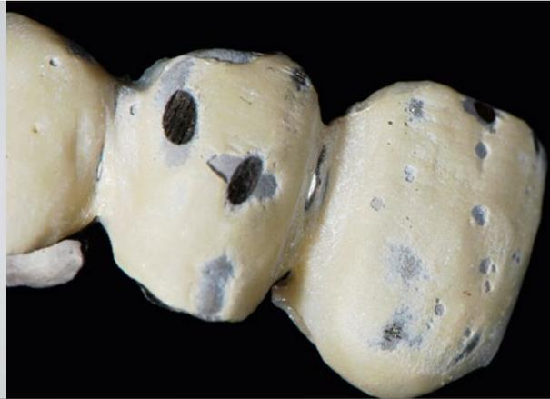
**01** So sieht ein Gussgefüge aus dem Labor aus, das auf einer Skala von 1 bis 10 (unbrauchbar bis sehr gut), trotz Poren, durchaus im oberen Drittel angesiedelt werden darf
