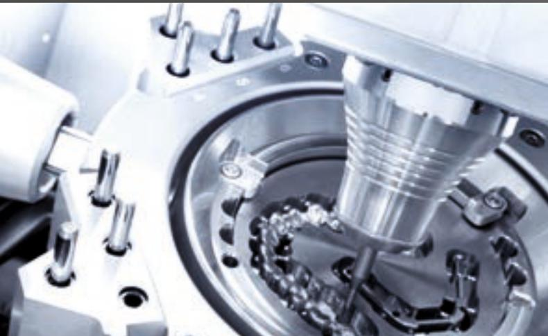
**08** CAD/CAM hat es ermöglicht: EMF-Verarbeitung ist sauber und präzise geworden. „Brenner-Romantik“ und Gusoxide können ersetzt werden (Bildquelle: ZirKonzahn)
