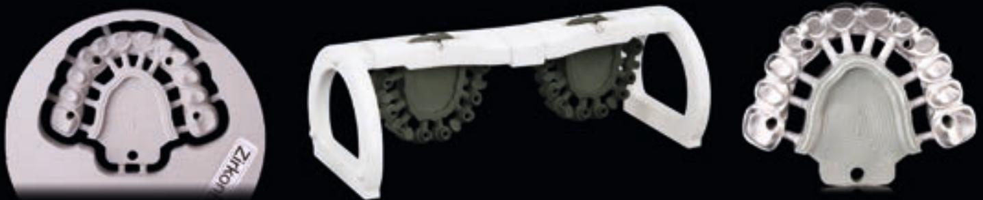
**13a - c** Ein Anbieter sintert mithilfe einer speziellen Halterung „frei hängend“ (Bildquelle: Zirkonzahn)
