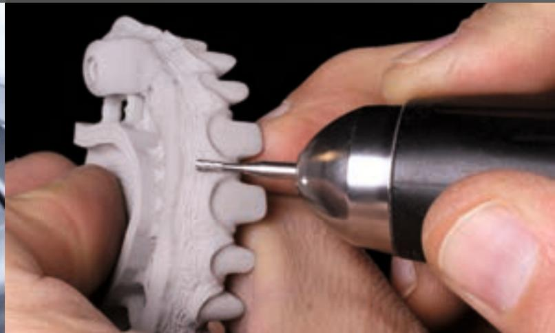
**09** Quasi butterweich, werkzeugschonend und schnell mit kleinen Fräsgeräten inhouse und vor dem Sintern mit diversen Werkzeugen materialschonend bearbeitbar – mit diesen Attributen werden die Green Metals beworben (Bildquelle: ZirKonzahn)
