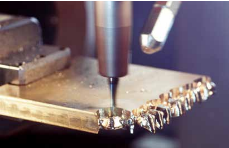
01 Fräsblank aus einer hochgoldhaltigen EM-Legierung von C.Hafner
