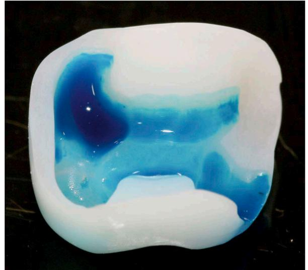
► 31 Die identische Tropfenmenge nach 30 Minuten Niederdruck-Plasma. Ein Aufsetzen ist nicht mehr möglich. Die Testflüssigkeit diffundiert sofort in die Oberfläche.
