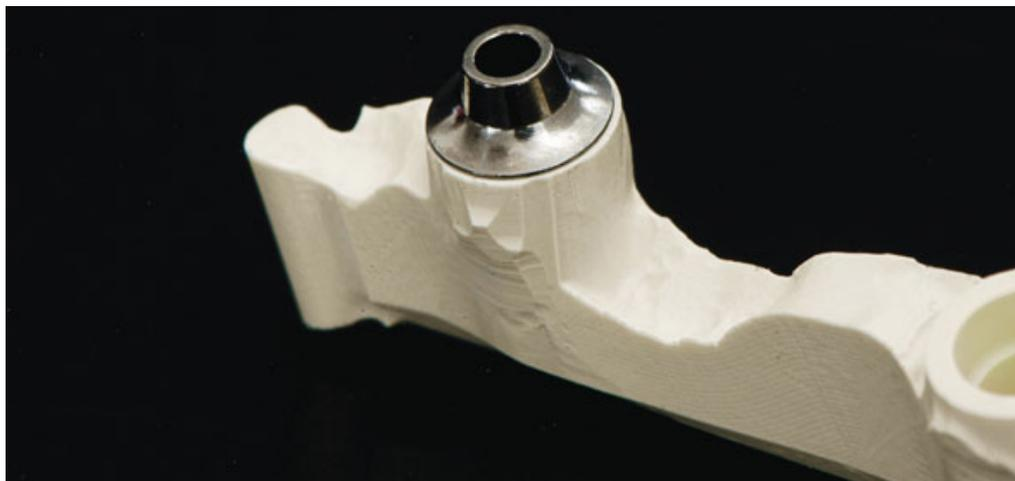
**Abb. 33** Bei richtiger Einstellung des Zementspalts im Dental Designer, einer entsprechenden Frässtrategie und mit dem richtigen Sinterprogramm sind perfekte Passungen der Klebasen in den Steg-Matrizen vorhersagbar.
